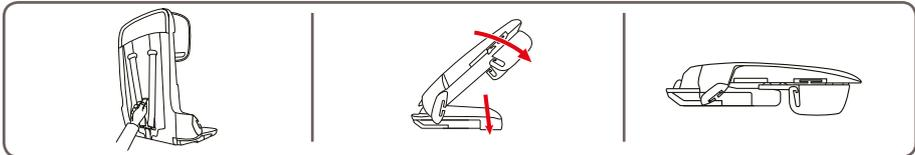
**2- Plegado del respaldo de la butaca:** presione y sostenga la base de la butaca con una mano y tire del cinturón de ajuste del respaldo con la otra mano, presione hacia abajo el respaldo, luego presiónelo lo más apretado posible.
