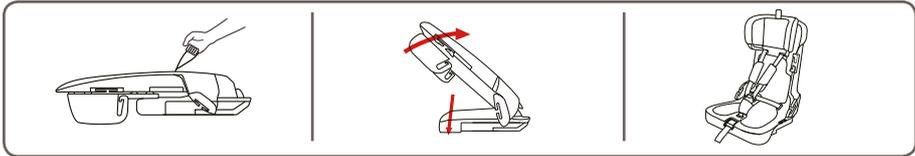
**1- Expansión de la butaca:** mantenga presionada la base con una mano y expanda directamente el respaldo con la otra mano, hasta que escuche el sonido del bloqueo del engranaje.
