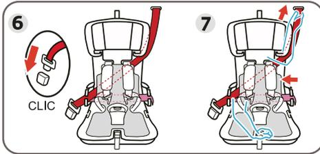
6- Inserte la lengüeta de metal del cinturón de seguridad en la hebilla del asiento del automóvil hasta que escuche un "clik" claro. Cuando el bebé alcance los 18 meses, retire todo el cojín interior.
