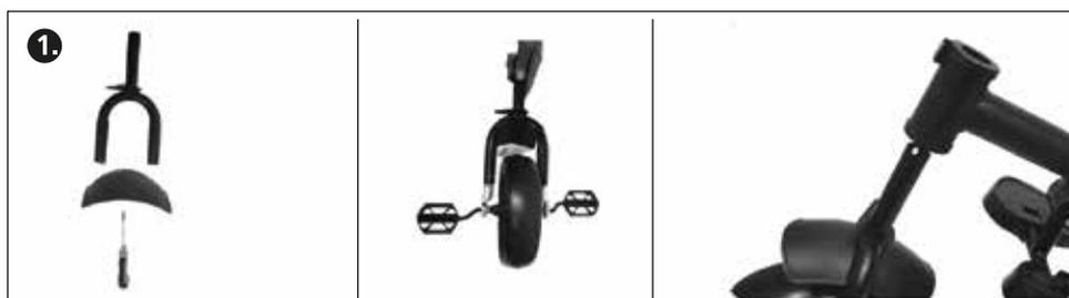
1. Coloque el guardabarros en la horquilla de la rueda delantera. Luego inserte la rueda delantera en la horquilla.
