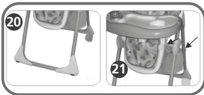
**10. Instalación de las ruedas:** coloque las dos ruedas con freno dentro de los orificios ubicados en la parte inferior de las patas traseras.
