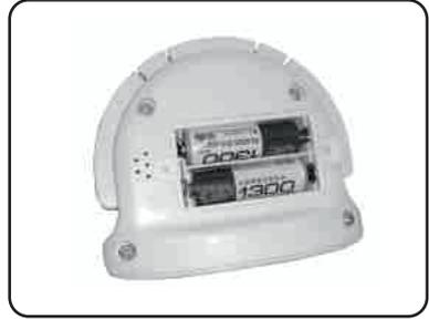
Retire la tapa de la batería e instale dos baterías AA en ella. Vuelva a atornillar la tapa de la batería y coloque la unidad entera en el tubo en forma de U.
