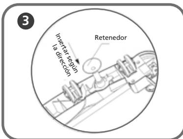
3. **INSTALACIÓN DE PARTES FIJAS:** Coloque cada una de las trabas en los agujeros ubicados en el centro de la base, luego inserte el retenedor desde la parte inferior de la base y ajústelo. (Pulse el botón, el retenedor puede moverse hacia arriba y hacia abajo, logrando así el propósito de fijación).
