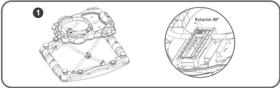
1. **APERTURA:** Fije primero el chasis, gire la perilla de seguridad del andador hasta la posición "—", levantarlo hasta la altura deseada, comprobar que permanezca en la posición de bloqueo y, por último, girar la perilla de seguridad hasta la posición "†".
