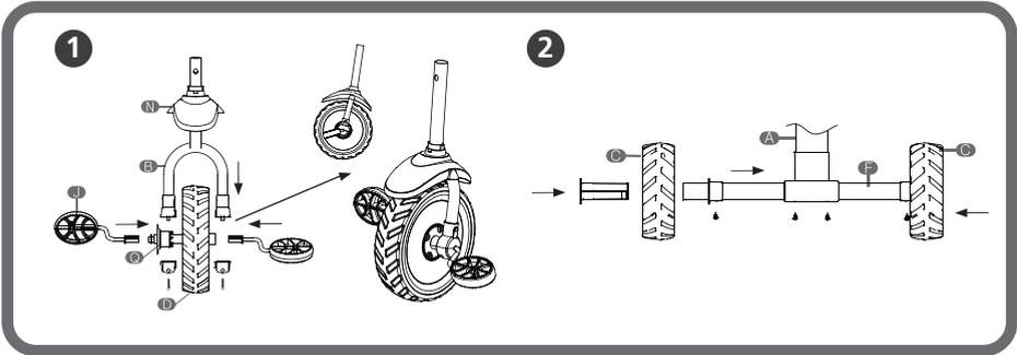
1. 1) Inserte los pedales en la rueda delantera (D), luego colocar la rueda en la horquilla delantera (B) y finalmente colocar los tornillos y ajustarlos hasta que quede correctamente fijada.
