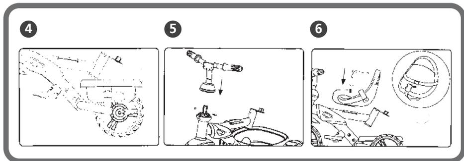
4. **Instalación del canasto trasero:** Alinee las anuras del canasto con las solapas de la horquilla trasera presionando hacia abajo hasta llegar al tope.
