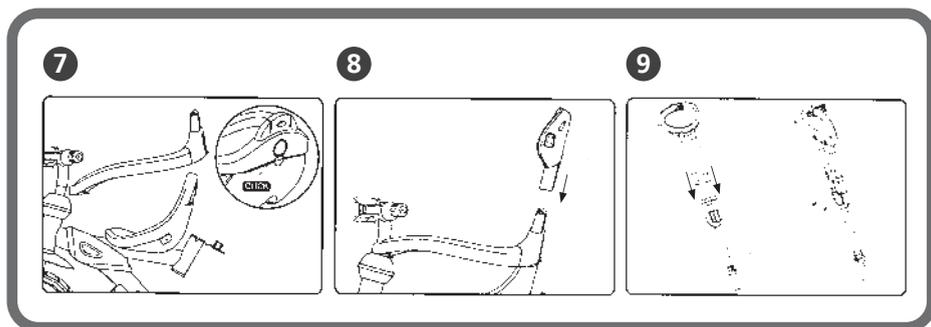
7. **Instalación de los barrales de seguridad:** Coloque la parte delantera del barral en el tubo del manubrio, a continuación baje la parte trasera para que se acople con el asiento. Presione hacia abajo hasta escuchar un "click", el cual indicará que ha quedado asegurado. Para quitarlo presione el botón que se encuentra en la parte trasera del asiento y tire el protector hacia arriba.
