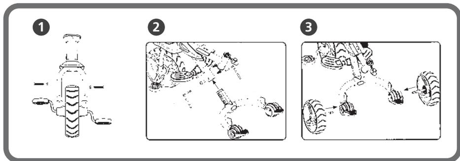
1. **Instalación del conjunto de rueda delantera:** Primero coloque el guardabarros en el poste de la horquilla delantera y luego inserte la horquilla en las terminales de la rueda presionando hasta que los agujeros coincidan. Coloque los tornillos en los agujeros y ajústelos hasta que la rueda este firmemente colocada.
